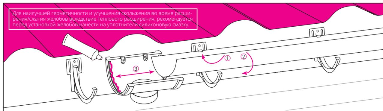
После того, как смонтированы все кронштейны и элементы, имеющие крепежные отверстия, установите желоба.
