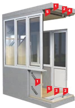
1. Плиты теплоизоляционные LOGICPIR Балкон
