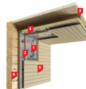
1. Плиты теплоизоляционные LOGICPIR Баня
