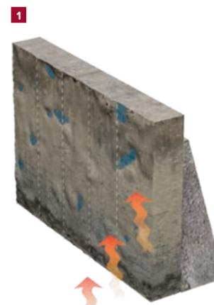
2. Из-за давления воды от стены может отслоиться обмазочная гидроизоляция.
