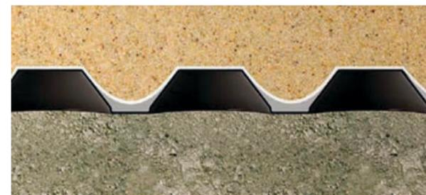
Поведение иглопробивного геотекстиля, скрепленного с выступами дренажного ядра
